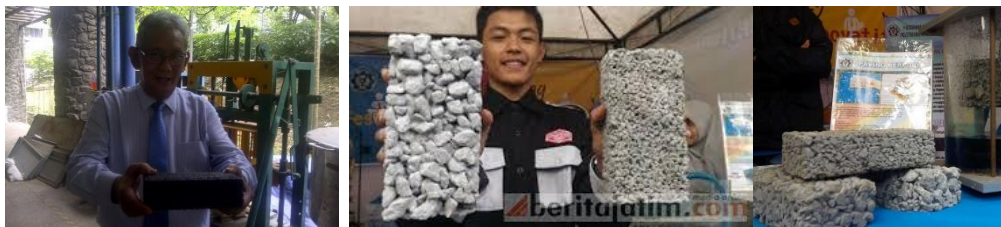
Gambar 1.4. Paving berpori penyerap air. Geopori (kiri) dan Paving Berpori (kanan) Sumber : okezone.com dan beritajatim.com
